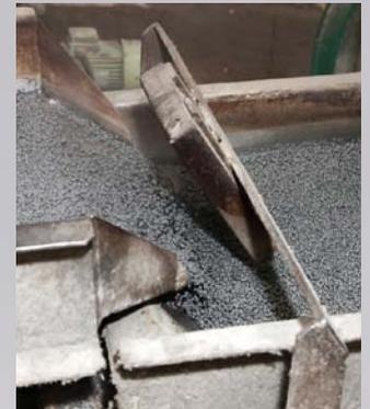
Der Verwerter mtm Plastics hat ein Verfahren entwickelt, um aus alten Gegenständen, die aus Hartkunststoffen bestehen, wiederverwertbares Regranulat (Bild unten rechts) zu produzieren.
