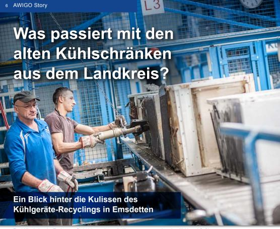
Zwei Mitarbeiter der Enviprotect GmbH demontieren die Kompressoren aus den alten Kühl- und Gefriergeräten.
