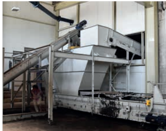
Durch den Windsichter in der Anlage sollen möglichst viele Plastikfolien aus dem Bioabfall gezogen werden.
