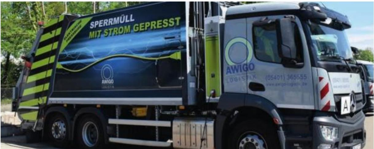
Bild 5: Darstellung eines Sperrmüllfahrzeuges der AWIGO LOGISTIK mit Elektroaufbau
