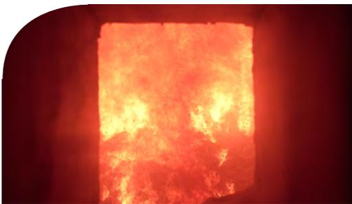
ausgerichtet, möglichst viel Energie aus dem Abfall in Dampf umzusetzen. Er wird während des Prozesses aus dem eingesetzten Kesselwasser gewonnen, auf 465 Grad überhitzt und schließlich zur Turbine im Maschinenhaus (Energiezentrale) geleitet.
